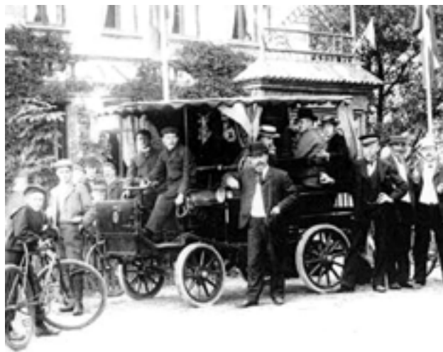
Den første benzinbus var åben. Der kunne dog sættes sejldugstag på køretøjet som beskyttelse mod sol og regn.
